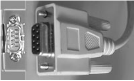
Նկ.2. COM-կայան , որը նախատեսված է արտաքին մոդեմի, անխափան սնուցման սարքի (UPS) և այլ սարքերի միացման համար
