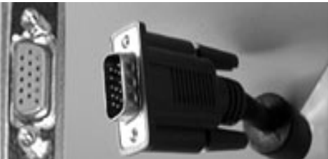
Նկ.4. SVGA-կայան , որը նախատեսված է մոնիտորի միացման համար, հնարավոր է մոնիտորի փոխարեն միացնել պրոյեկտոր:
